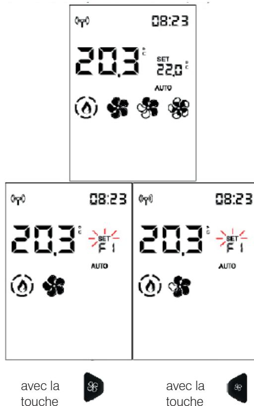
Le réglage de la ventilation a lieu séquentiellement pour les différents ventilateurs (si présents). Si le produit n'est pas canalisé, seul un ventilateur est présent (F1).
